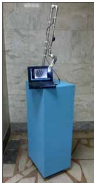
Рис. 1. Общий вид макетного образца импульсно-периодического CO 2 -лазера с поперечным разрядом.
