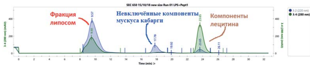
Рис. 7. Гель-размерная хроматограмма восстановленных после лиофильной сушки липосом мускуса кабарги (хроматографическая колонка Enrich SEC 650; 4,6×300 мм; 10 μm).
