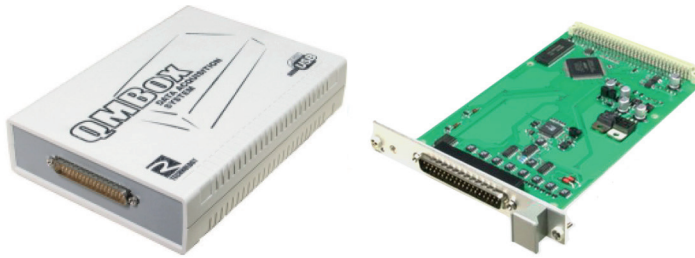
Рис. 2. Устройство QMS17 (слева), материнская плата (справа). Fig. 2. QMS17 device (left) and its motherboard (right).
