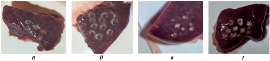
Рис. 7. Воздействие на охлаждённые образцы печени свиньи в непрерывном (а — 6 Вт, б — 10 Вт) и в импульсном режиме (в — 6 Вт, з — 10 Вт).
